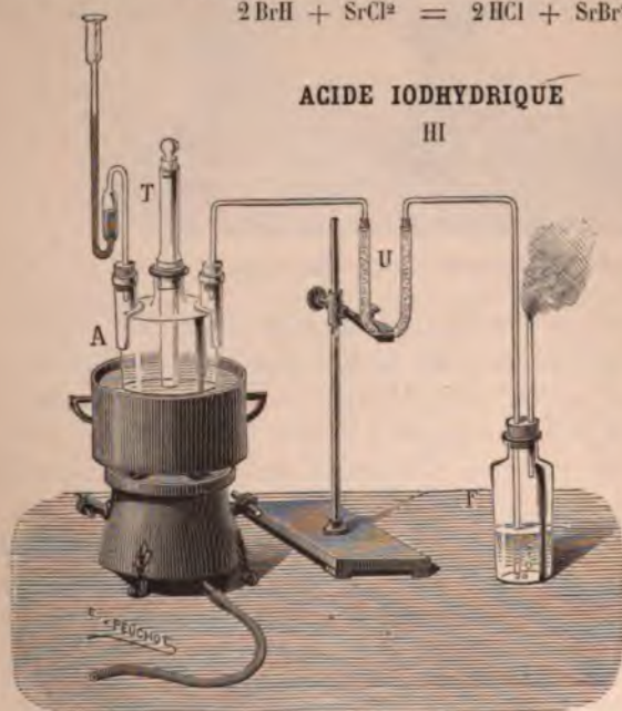
Fig. 67. — Préparation de l'acide iodhydrique.
